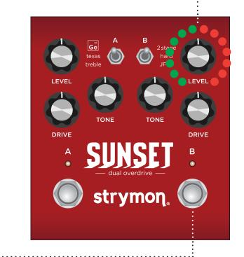
BチャンネルのLEVELを回して、 バイパス・モードを切り替えます。
