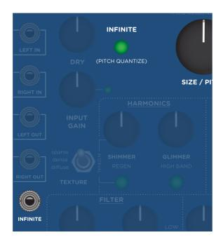
INFINITE CV: リバーブに入力される入力信号をホールドします。
