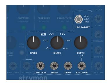
**SHAPE/シェープ:**6つの波形(triangle、square、ramp、saw、random、envelope) LFOから選択します。Envelopeは入力信号のダイナミクスに追従します。 その感度はDEPTHノブで調整します。
