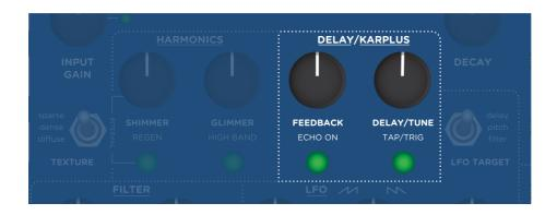
**DELAY/TUNE:**ストリングチューニングを4オクターブの範囲で設定できます。 SIZE/PITCH CV入力信号で12セミトーンのチューニングも可能です。
