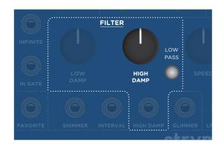
**LOW PASS/ローパス:** HIGH DAMP 機能をリバーブ出力に効く24dB/octローパスフィルターに切り替えます。
