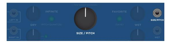
**SIZE/PITCH CV:**1V/オクターブでサイズ/ピッチ設定を変更します。 SIZE/PITCHノブの位置は影響しません。
