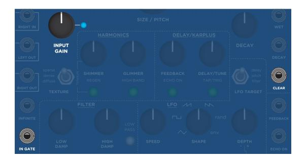
**IN GATE CV**: CVが高い時、リバーブへの入力をゲートします。入力信号がゲートされリバーブに送られない時、INPUT GAIN LEDはブルーに点灯します。
