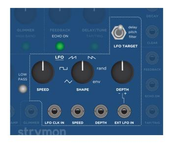
**LFO TARGET/LFOターゲット:**LFOでモジュレートする以下のターゲットをセレクトします。
