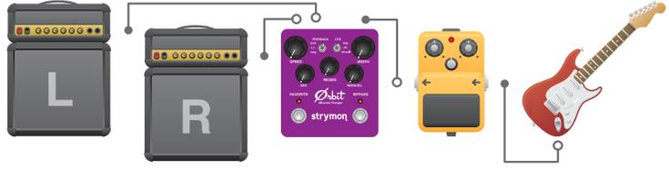
ギターアンプのエフェクトループに本機を設置する接続例です。L側ギターアンプの Send から本機を経由して、L側とR側両方の Return に戻すことでステレオ仕様にすることができます。
