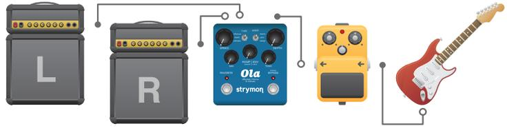
ギターアンプのエフェクトループに本機を設置する接続例です。L 側ギターアンプの Send から本機を経由して、L 側と R 側両方の Return に戻すことでステレオ仕様にする事ができます。
