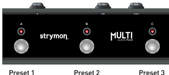
**NOTE :** MultiSwitch Plusのフットスイッチ A、B、および C は、MIDI プログラムチェンジ1、2、および3に対応します。
