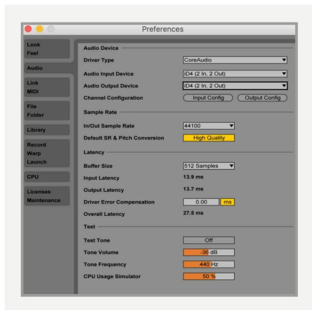
iD Mixerで入力信号をモニターしている場合は、コンピューターの負荷を軽減するために、バッファサイズは比較的高く設定できます。このケースでは、Ableton側のトラックの入力モニタリングをオフにします。
