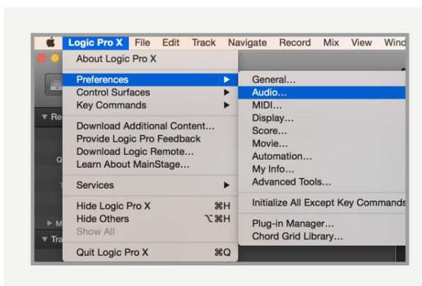
セッションを適切なバッファサイズに設定して下さい。出力のモニター用にMonitor Mixノブを使用して、バッファサイズをコンピューターに負荷がかからない程度の適切なレベルに設定します。再生時に不安定になったり、エラーが起る場合はバッファサイズを上げてみてください。
