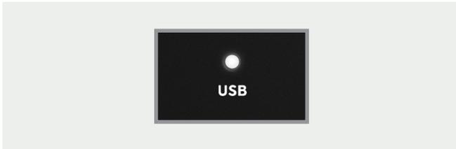
コンピューターとiD44の正常な接続状態は、USB LEDの点灯で確認できます。
