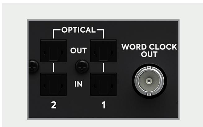
S/PDIFモードでは、外部デジタル機器との接続や4チャンネルのオーディオ入出力として使用できます。最高サンプリングレートは96kHzです。
