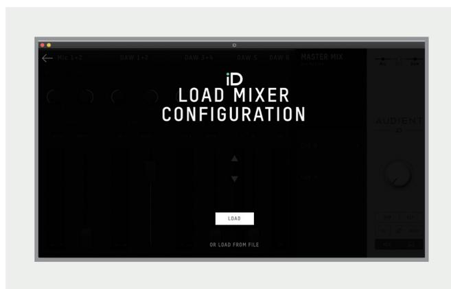
以前に保存したプリセットはリストに表示されます。ロードしたいプリセットを選び、Loadをクリックします。mixer configurationを開いてLoad From Fileを選んでファイルをロードすることもできます。
