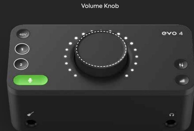
入力ボタンを押してボリュームノブを回し、マニュアルで変更できます。その際、ノブの周りのLEDがゲインレベルを表示します。
